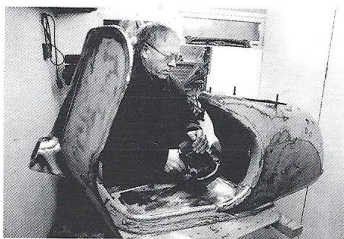
Mogens tvillingebror, Mekaniker Jørn, ville ikke have noget at gøre med slibning og polering. Her ses Mogens i gang med den elektriske excenter slibemaskine.
